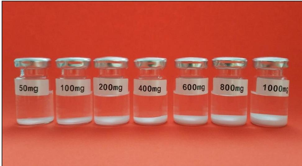
Abb. 3: Natriumtartrat Dihydrat ist schwer löslich in Methanol, die Extraktionsausbeute (Recovery) kann nicht visuell bewertet werden.
