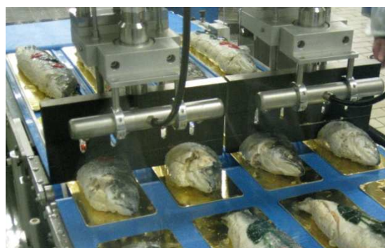
Pré-tranchage de poisson garni sur 4 pistes
